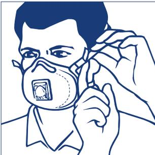
5. Die Spannung der Bänder kann gelockert werden ohne die Maske vom Gesicht zu nehmen, indem Sie mit den Fingern in die Klemmschnallen drücken.
